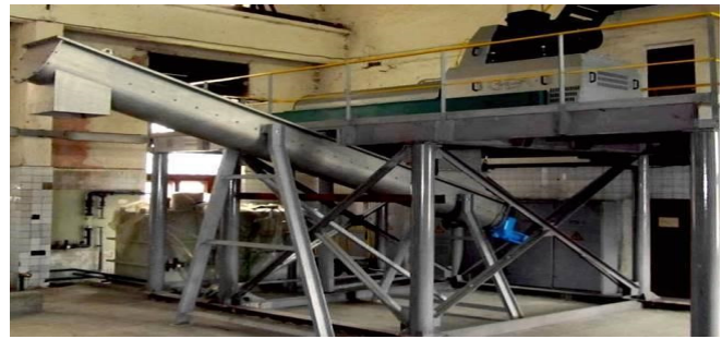
Рис.5. Компонировка расположения декантера и транспортера.
