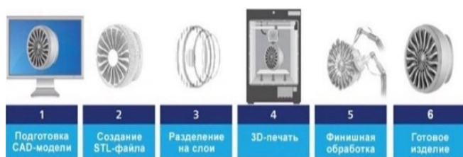
Рис. 2. – Общая схема аддитивного производства
