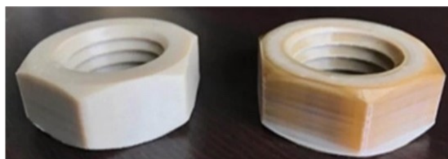
Рис. 3. — Детали, напечатанные с прогревом камеры и без прогрева [11]
